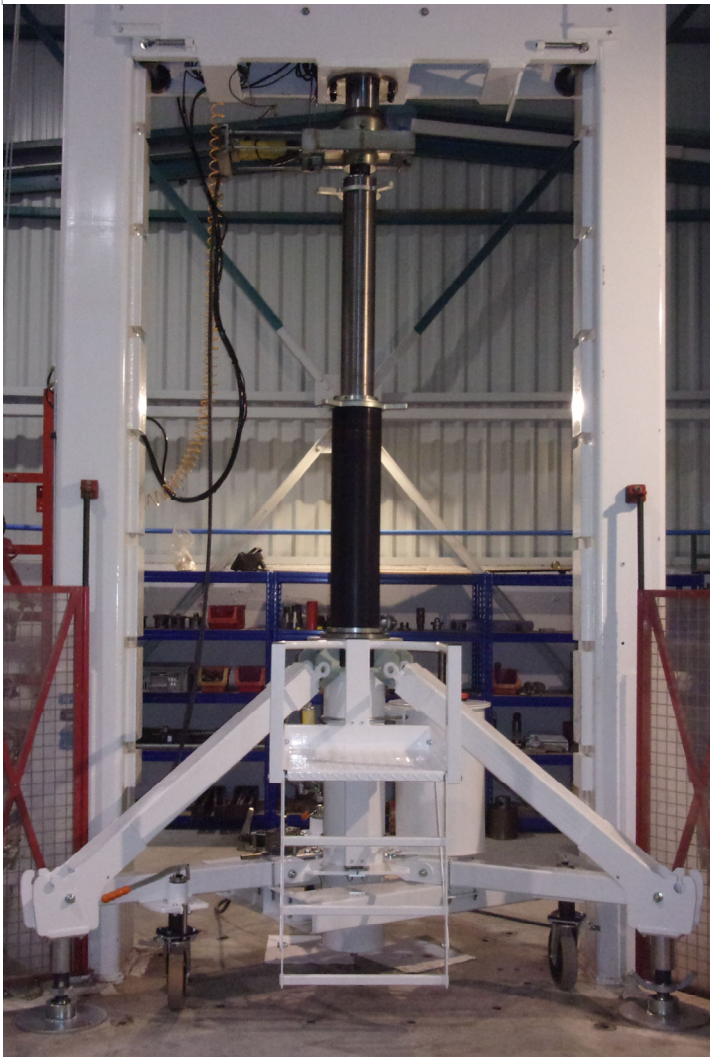
Tests of a hydraulic tripod (35 T nominal capacity) at 52.5 T in vertical and 5.25 T in horizontal simultaneously. Essais d'un tripode hydraulique (capacité nominale de 35 T) à 52.5 T en vertical et à 5.25 T en horizontal simultanément.
